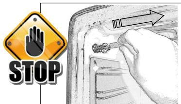
Als de contactbus verwijderd wordt bij de aanvang van het bakken, blokkeert het bedieningsinstrument de oven en verwittigt deze de fout via een geluidssignaal: de contactbus opnieuw inbrengen om het bakken verder te zetten!
