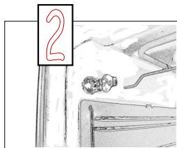
Introduzca el conector hasta el fondo : si se ha introducido de forma correcta, el sistema de control avisará con una doble señal acústica.
