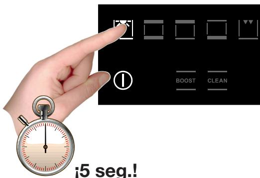
Para desactivar la modalidad demostración toque durante cinco segundos el símbolo de la luz: el sistema de control entrará en funcionamiento normal y estará listo para el encendido.
