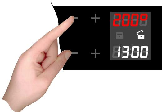
Durante el calentamiento, el símbolo de grados centígrados ( $^{\circ}\text{C}$ ) parpadea para indicar la regulación del calor para alcanzar la temperatura seleccionada.
