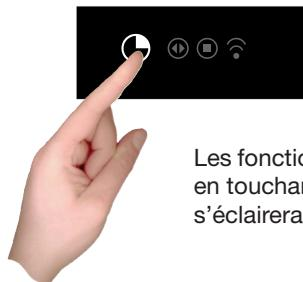
Les fonctions peuvent être sélectionnées en série, de gauche à droite, en touchant le symbole de l'horloge : à chaque pression, un symbole s'éclairera en série.
