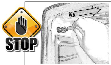
Se o pino for extraído depois da cozedura ter iniciado, o controlo bloqueia o forno e avisa o erro com sinais sonoros: introduzir de novo o pino para continuar a cozedura!
