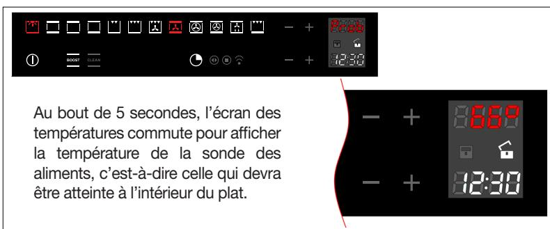
Au bout de 5 secondes, l'écran des températures commute pour afficher la température de la sonde des aliments, c'est-à-dire celle qui devra être atteinte à l'intérieur du plat.
