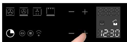
De klok regelen met de toetsen + en - : tijdens het instellen knipperen de scheidingspunten, het uur wordt verkregen als de punten vast zijn.
