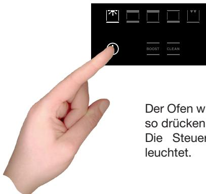
Der Ofen wird eingeschaltet, wenn Sie das Symbol ON/OFF so drücken, wie auf der Abbildung zu sehen.
