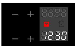
Blokering ingeschakeld : symbool rood slotje gesloten op display : elke handeling verbonden aan het gebruik van het bakken is uitgeschakeld.
