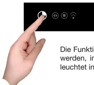
Die Funktionen können in Reihenfolge von links nach rechts gewählt werden, indem Sie das Uhr-Symbol berühren: Bei jeder Berührung leuchtet in Folge ein Symbol.
