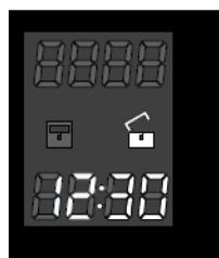
Una volta definita l'ora di fine cottura, il display visualizzerà ancora l'ora corrente, il simbolo “fine cottura” sarà acceso.
