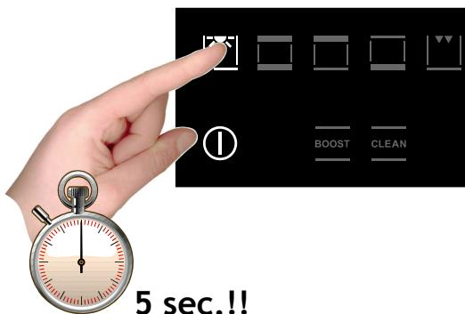
Pour désactiver le mode démonstration, toucher pendant cinq secondes le symbole de la lumière: le contrôle se mettra en position de fonctionnement normal et prêt pour l'allumage.
