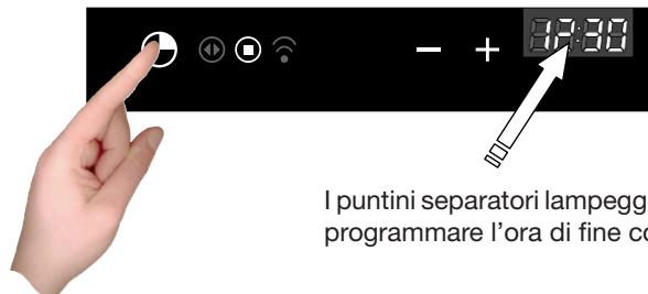
I puntini separatori lampeggiano ad indicare che è possibile programmare l'ora di fine cottura
