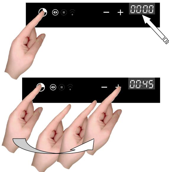
I puntini separatori lampeggiano ad indicare che è possibile programmare il tempo di cottura
