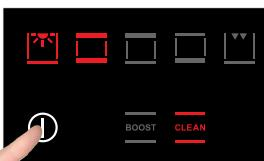
Toque el símbolo on/off durante por lo menos tres segundos para activar o desactivar, alternativamente, el bloqueo del horno:
