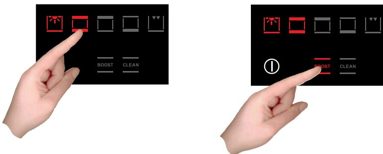
In ogni momento è possibile disinserire la funzione "turbo heat" o cambiare funzione di cottura.
