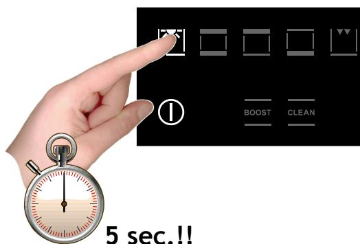
Um die Vorführmodalität zu deaktivieren, berühren Sie fünf Sekunden lang das Licht-Symbol: Die Steuerung geht in die normale Betriebsart über und kann nun eingeschaltet werden.
