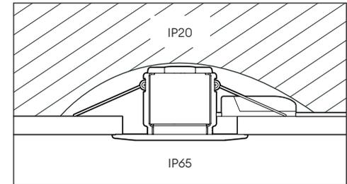
\*The product is insulation coverable | Ce produit est recouvrable de tous types d'isolants
