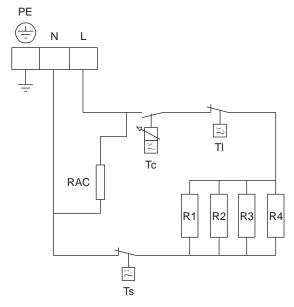
R1, R2, R3, R4 Resistencias principales Resistencias principais Main heating elements
