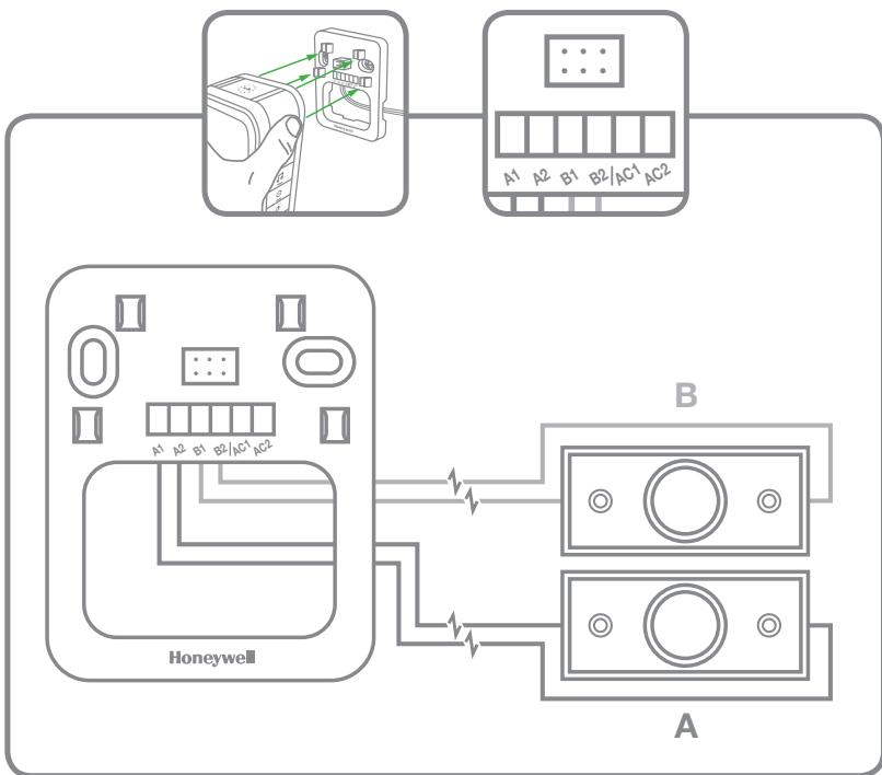
**GB** Wired illuminated push with transformer **DE** Verdrahteter Druckkaster mit Beleuchtung und Transformator **FR** Bouton pousoir éclairé câblé avec transformateur
