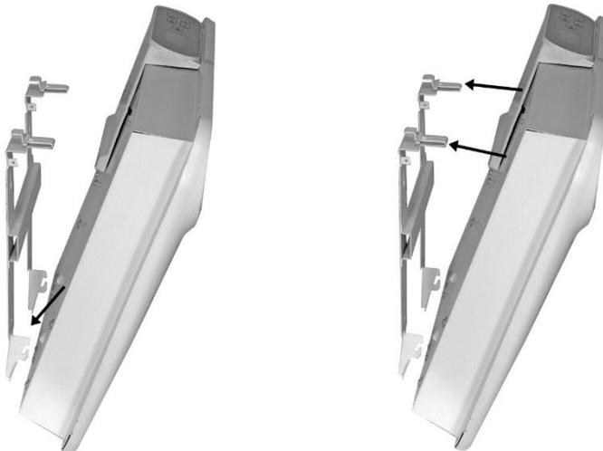
S'il est correctement installé, le chauffage sera solidement fixé aussi bien en haut qu'en bas.
